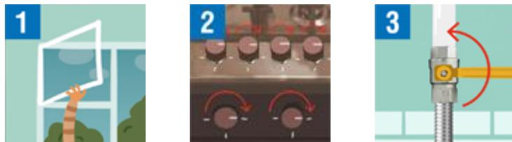
2. Зажженную спичку нужно поднести к горелке, затем открыть кран включаемой горелки, при этом газ должен загораться во всех отверстиях горелки.
